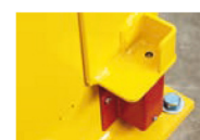
Interbloqueo (interruptor magnético y sistema de enganche)
