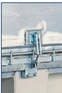
Seguro anti-vuelco para modelos de longitud inferior a 1.065 mm.
