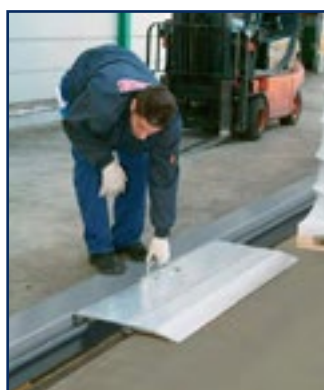
Apoyar la punta de la pestaña sobre el piso del vagón y colgar el gancho dentro del raíl.
