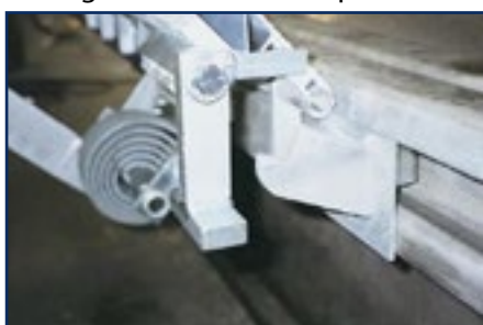
El seguro anti-caídas engrane automáticamente al levantar la pasarela
