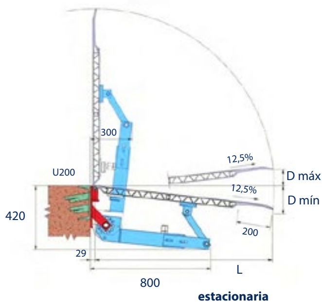
Elevador con resortes de compensación, a partir de longitudes de 1.065 mm, que permite bajar y levantar la pasarela sin esfuerzos.
