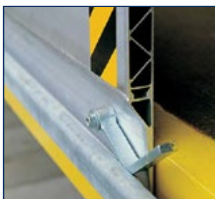
Apoyar la punta de la pestaña sobre el piso del vagón y colgar el gancho dentro del raíl.
