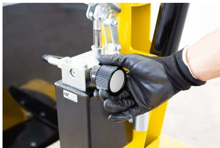
Detalle de la bomba manual y la perilla de descenso.
