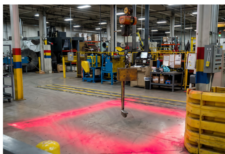
Muestra de la configuración en cuadrado para delimitar la zona de trabajo.
